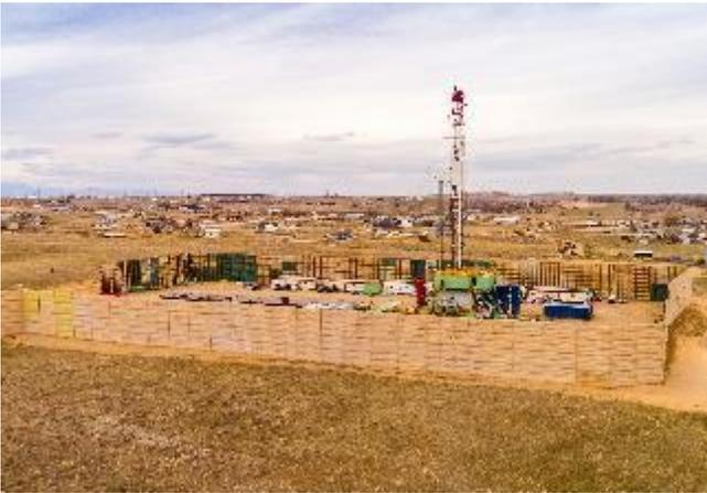
Utilizamos plataformas de perforación mejoradas con características de reducción de ruido y tecnología de fracturación hidráulica silenciosa. También utilizaremos un equipo de perforación eléctrico, el cual también reduce el ruido. Estas características reducen el ruido de nuestras operaciones. Además de mitigar el ruido en la fuente, también instalaremos paredes antisonoras.
